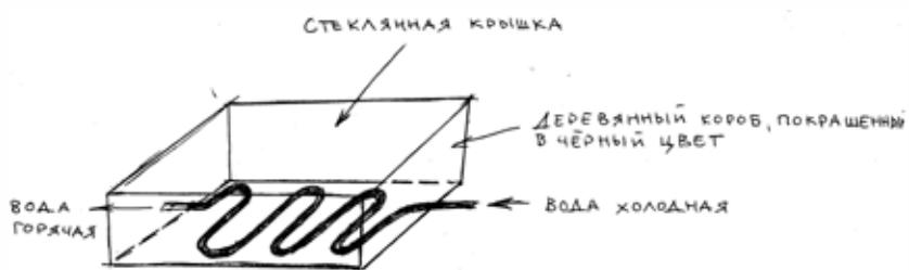
Схема простейшего солнечного нагревателя воды
